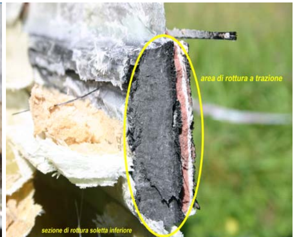
Foto 7: sezione di rottura della soletta inferiore.
