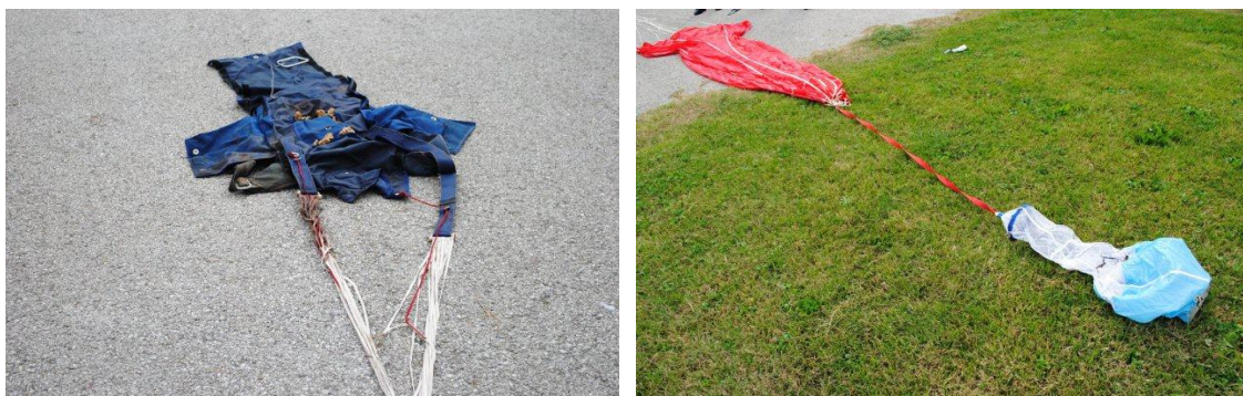
Foto 22 e 23: paracadute del pilota parzialmente dispiegato.
