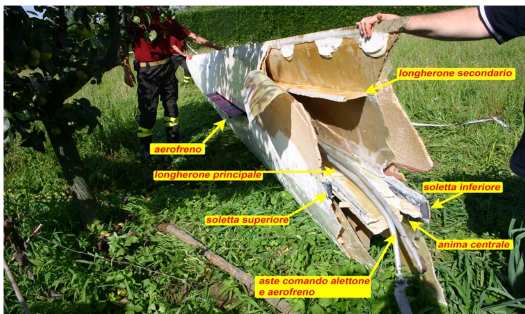
Foto 5: sezione di rottura della semiala destra.
