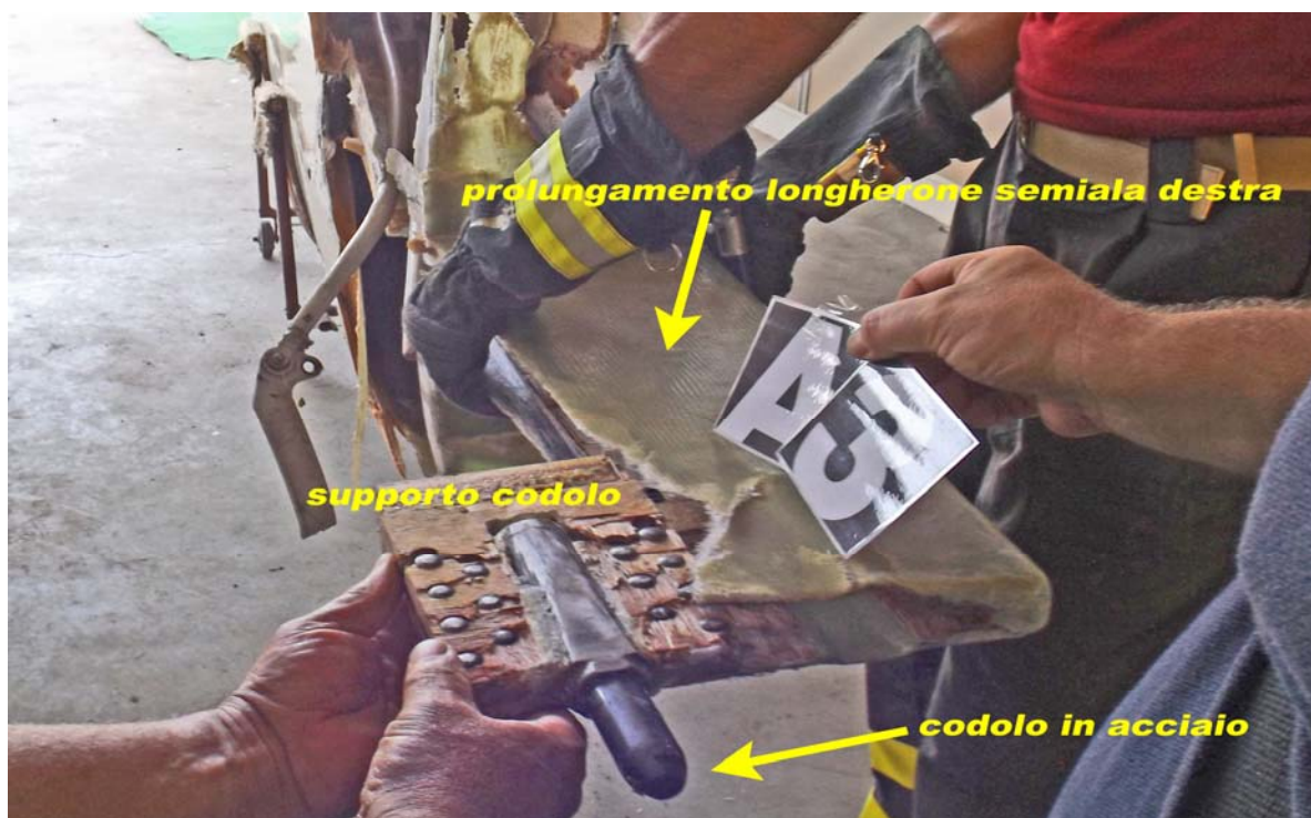
Foto 17: rottura del supporto del codolo in acciaio.
