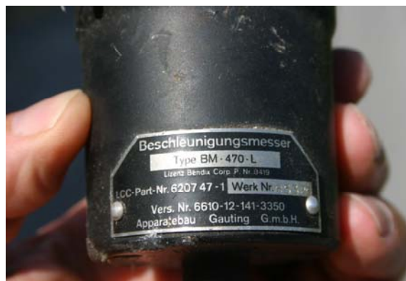
Foto 21: dati identificativi accelerometro.
