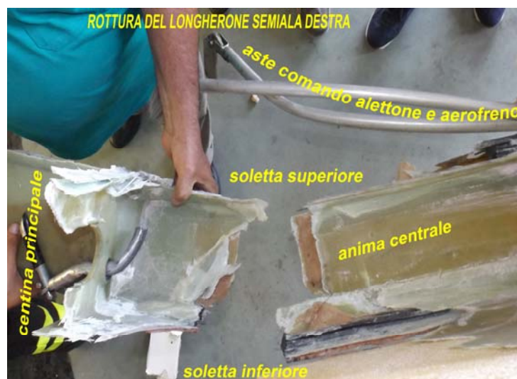
Foto 8: sezioni di rottura del longherone.
