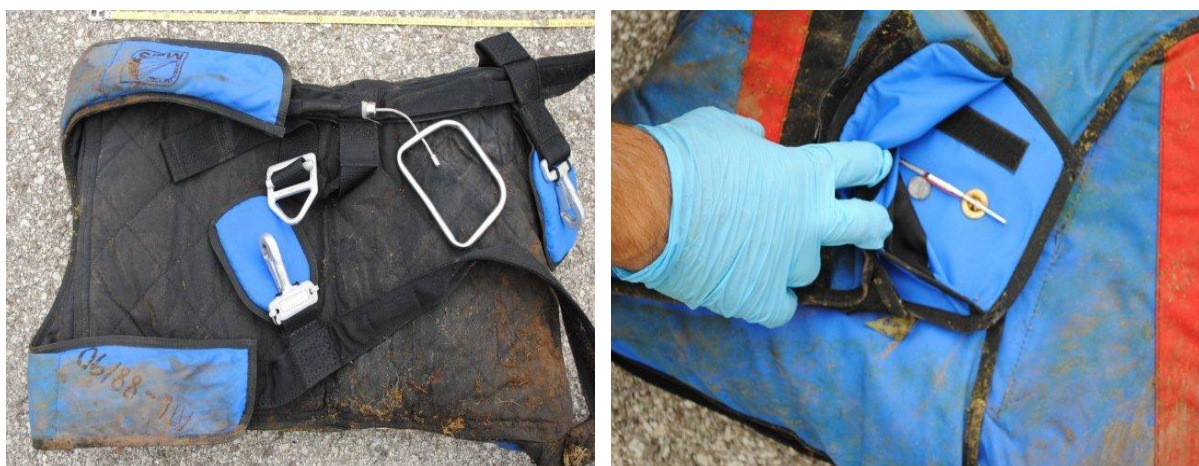
Foto 24 e 25: paracadute del passeggero pilota non attivato.
