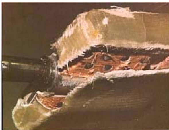
Foto n. 26: rottura supporto codolo durante test statico. Foto n. 27: rottura soletta superiore durante test statico.
