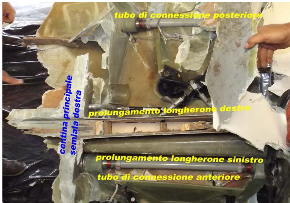
Foto 12: prolungamenti dei longheroni alari e tubi di connessione.
